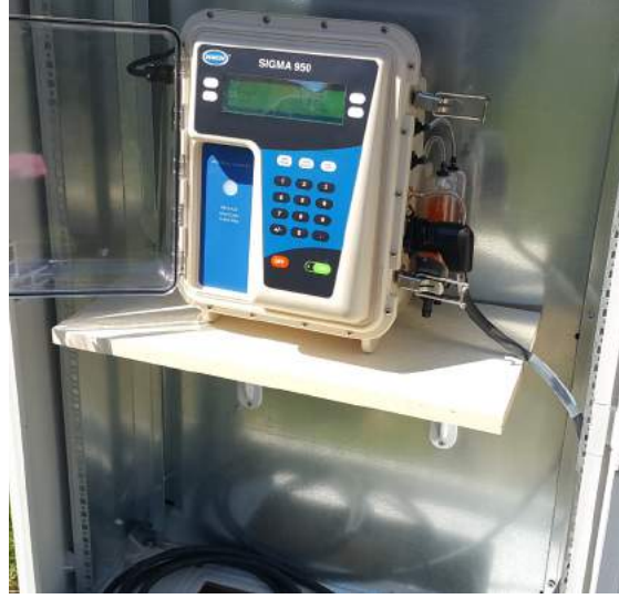
Yağmur Suyu Debi Ölçer
